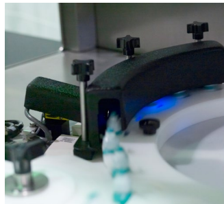
Маркировка на дне флакона. Защитный экран лазера показан черным
